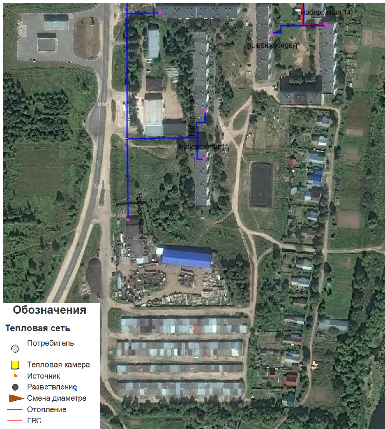
Рис.1.1 Схема тепловых сетей котельной д.Филино с привязкой к топографической основе.
